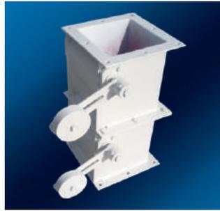
Válvulas de doble compuerta accionadas por peso
