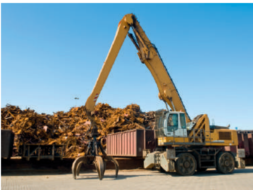
Almacenamiento en una planta de reciclaje de desguace: aquí se generan, entre otros, polvos metálicos peligrosos, que se pueden eliminar con sistemas de colección de polvo de Deichmann.
