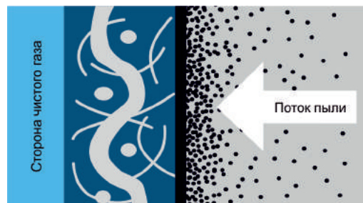
Принцип поверхностной фильтрации *
