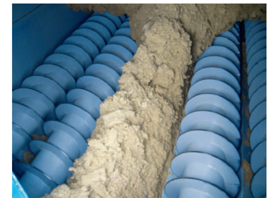
Шнеки для сбора пыли в бункере Deichmann
