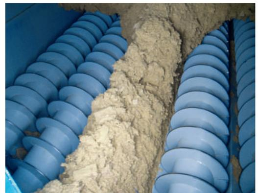
Deichmann Staubsammelschnecken in einem Staubbunker
